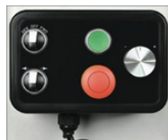
OVLÁDACÍ JEDNOTKA S MAGNETEM PRO PŘÍPEVNĚNÍ KAMKOLI NA SOUSTRUH
